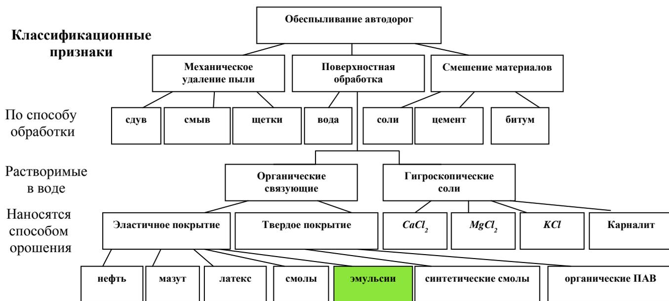
Рисунок 1 – Классификация методов борьбы с пылью при эксплуатации карьерных автодорог и техногенных массивов
